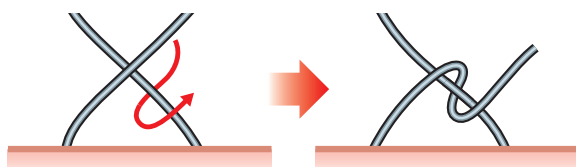
Рисунок 3.2. Формирование полуузла. Скрестите концы нити и проведите один конец под перекрестом на противоположную сторону.
